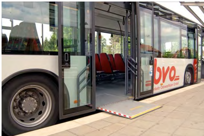
Abbildung 23: Beispiel für eine ausklappbare Rampe im Fahrzeug
