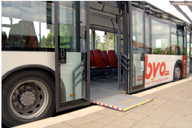
Abb. 10: Ausklappbare Rampe im Fahrzeug
