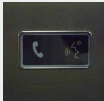
Das linke Symbol zeigt gelb an, wenn ein Notruf abgegeben wurde, das rechte leuchtet grün auf, wenn der Notruf ange-nommen wurde
