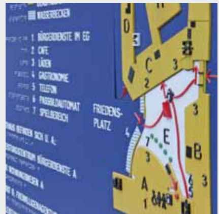
Der Übersichtsplan ist durch erhabene Elemente und taktile Beschriftung für blinde Menschen tastbar
