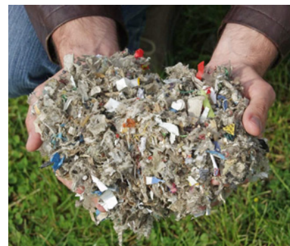
So sieht der Ersatzbrennstoff aus, der in der Anlage in Ennigerloh aus eurem Restmüll entsteht (GEG)
