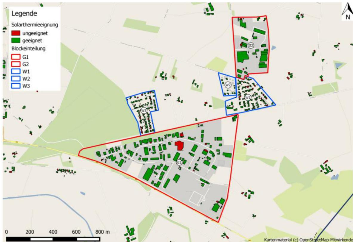
**Abb. 46: Übersicht geeigneter Dächer zur Solarthermienutzung in den Schwerpunktbereichen**
