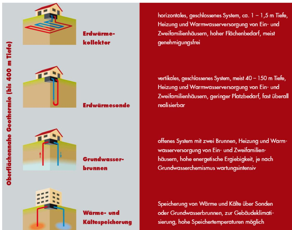
Abb. 38: Nutzungsmöglichkeiten oberflächennaher Geothermie<sup>35</sup>
