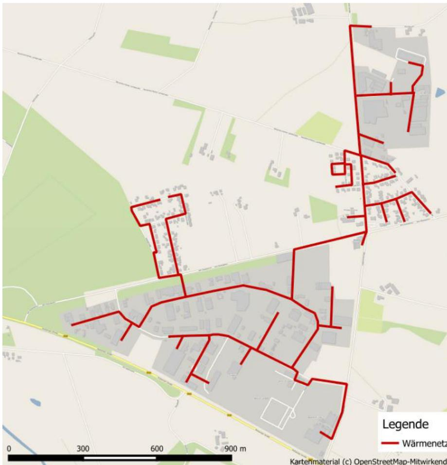
**Abb. 44: Grobauslegung Wärmenetz**
