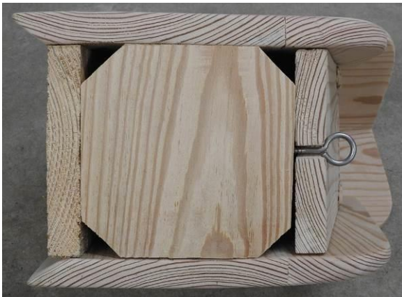
Ansicht von unten: Die abgeschnittenen Bodenecken dienen der besseren Drainage. Die Ringschraube ist der Verschluss.
