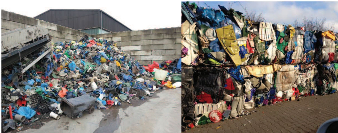
Abbildung 24: Zur Transportoptimierung werden Kunststoffhohlkörper am Umschlagplatz zerkleinert oder balliert
