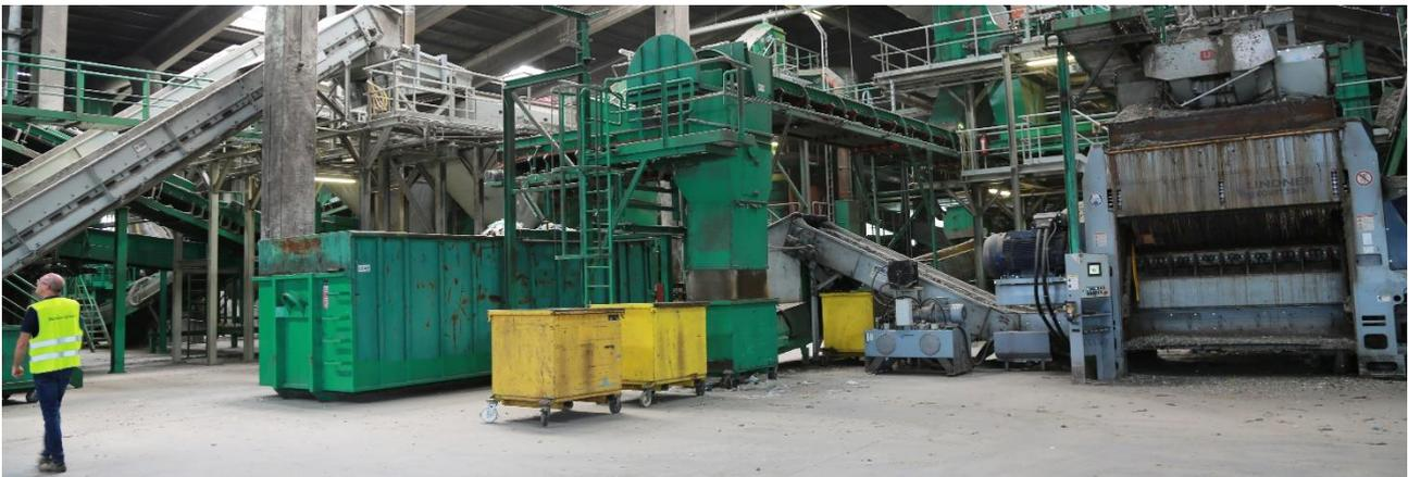
*Abbildung 10: Nachzerkleinerer in der MBA-Anlage*
